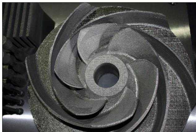
Головной образец, отпечатанный по технологии ЦНИИТМАШ, пройдёт в “ОКБМ Африкантов” осмотр и рентгенографию. Изделие разрежут, оценят его плот-
