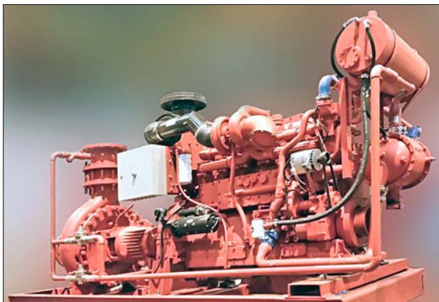
Комплектация и вариант исполнения насосных агрегатов определяются согласно специальным требованиям проектов. Установки серии ДНУ применяются для разных типов жидкостей, которые отличаются по вязкости, плотности, степени загрязнённости, температуре. На площадке СЗЭМ выпускаются агрегаты для перекачивания топлива, пульпы, пищевых жидкостей, лакокрасочной продукции, кислот, воды (грязной, солёной, высокой температуры, чистой).
