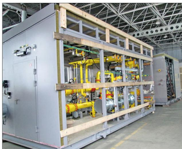
Установка подготовки топливного газа – это многофункциональный комплекс, включающий в себя несколько блок-боксов с оборудованием различного назначения, которые при монтаже стыкуются между собой в единое здание с общей кровлей. УПТГ "ЭНЕРГАЗ" обеспечит энергоагрегаты газом с установленными проектными параметрами по чистоте, температуре, давлению и расходу.
