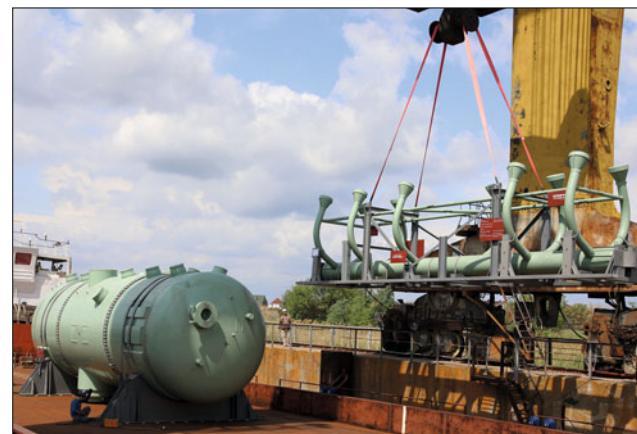
**Волгодонский филиал компании АЭМ-технологии (входит в машиностроительный дивизион Росатома – Атомэнергомаш) изготовил и отгрузил парогенератор для Балаковской атомной электростанции. Оборудование предназначено для замены аналогичного аппарата на третьем энергоблоке станции. Замена будет осуществляться в рамках масштабной модернизации энергоблока № 3 с целью улучшения теплогидравлических характеристик.**
