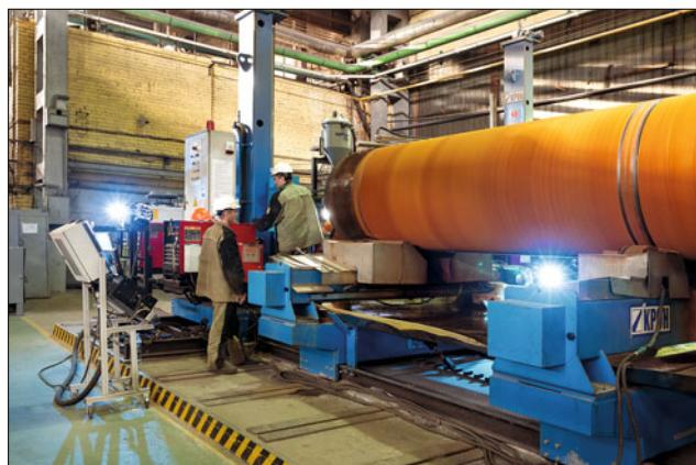
До появления этого оборудования электрошлаковая наплавка труб и коллекторов парогенераторов производилась на “Петрозаводском маш” двумя комплексами фирмы STEEL MEC. За время работы на них наплавлено более километра трубных заготовок и более 60 коллекторов. Ввод в работу третьей наплавочной установки позволил сохранить темп
