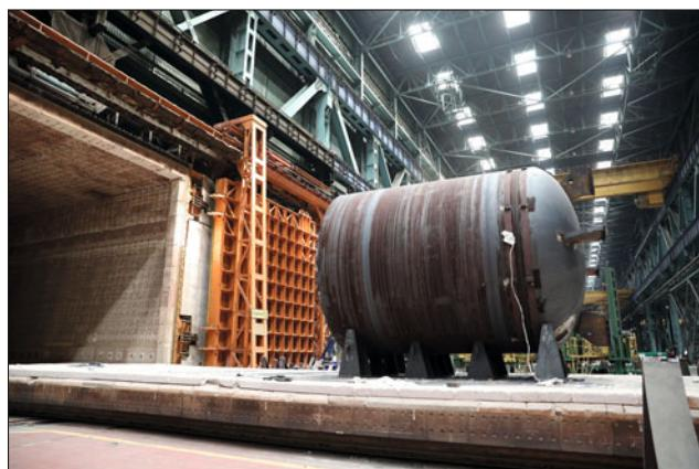
После термообработки конструкция поступила на этап проведения контролей сварных соединений. В дальнейшем полукорпус будет подготовлен для нанесения внутренней коррозионностойкой наплавки в зонах сварных швов.
