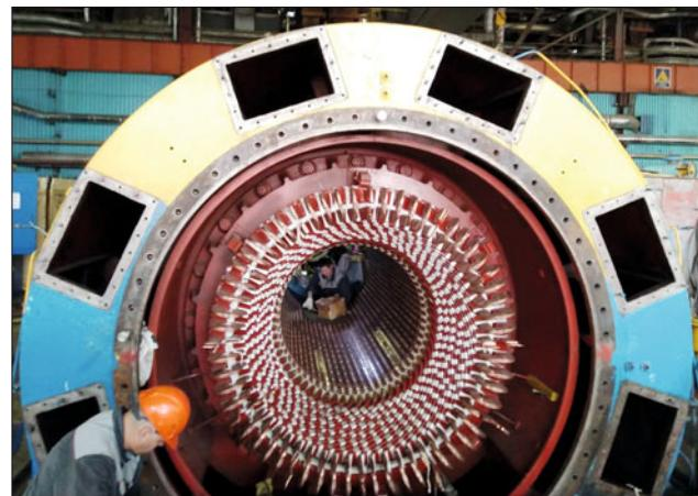
В ходе обновления данного генератора также осуществляется модернизация его системы водородного уплотнения, щёточно-контактного аппарата с установкой автоматизированной системы мониторинга.
