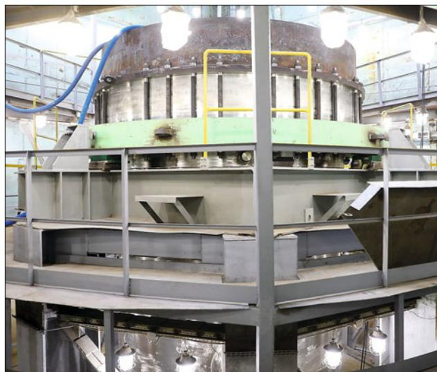
Далее корпусу реактора предстоит пройти вакуумные испытания и сборку с кожухом. Итогом всех исследований станут контрольная сборка всех элементов научно-исследовательского реактора и пневматические испытания.
