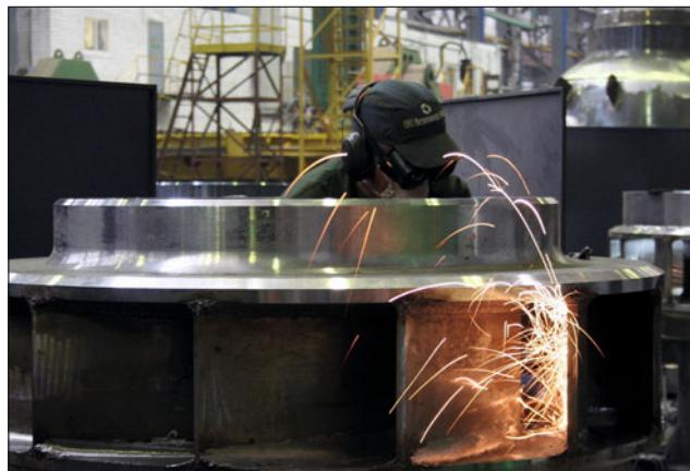
После сварки изделие нагревают до 300°C. С помощью мостового крана грузоподъёмностью 250 т специалисты перемещают изделие в печь на термообработку на 6 суток. Следующий этап изготовления атомного реактора для первого блока АЭС Руппур – сварка обечайки и днища нижнего полукорпуса.
