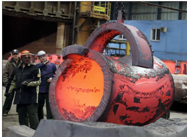
Второй этап – штамповка изогнутых колен ГЦН. Готовые трубы разрезаются вдоль, и уже четыре заготовки пройдут нагрев в печах и с помощью пресса их загнут на 29°.
