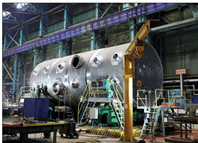
Предварительно корпус парогенератора собрали из четырёх обечаек и заварили между собой. В процессе сварки в общей сложности было использовано более 2000 кг флюса и более 12 000 м проволоки.
