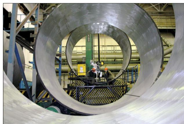
В настоящее время на Петрозаводском машзаводе изготавливают цилиндрические части корпусов ёмкостей СПЗАЗ – обечайки. На листогибочной машине заготовкам из нержавеющего листового проката придают форму цилиндра с внутренним диаметром более 4 м. Затем выполняют продольный сварочный шов.
