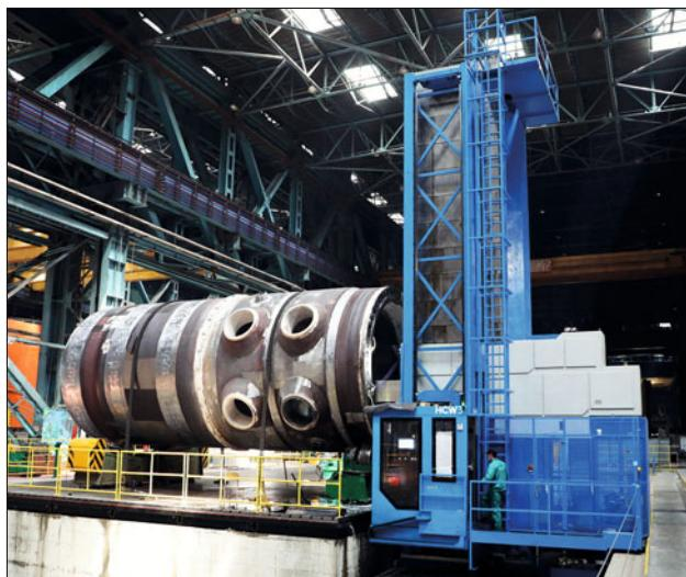
Оборудование способно выполнять финишную механическую обработку и нарезание резьбы главного разъема корпуса реактора. Таким образом, срок выполнения данной операции сократился в 1,5 раза. Максимальная масса обрабатываемых изделий достигает 600 т. На станке установлена современная система ЧПУ, что позволяет растачивать, сверлить фрезеровать плоские и криволинейные поверхности по программе в двух и трёх плоскостях, а также нарезать резьбу по интерполяции.
