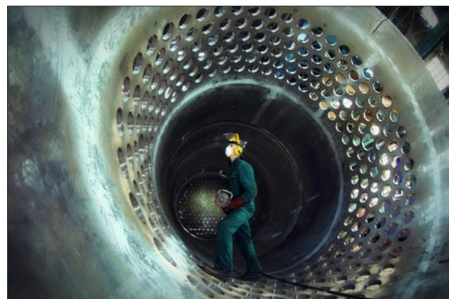
В верхней части шахты находятся 238 отверстий диаметром 196 мм и два отверстия диаметром 300 мм. Отверстия расположены в специальном порядке – 6 рядов по периметру обечайки – и предназначены для выхода теплоносителя. На днище изделия имеются отверстия разного диаметром 40 и 60 мм (1344 отверстия), а также 163 отверстия диаметром 226 мм. Они предназначены для установки опор и защищают тепловыделяющие сборки (ТВС) от попадания в них механических частиц.
