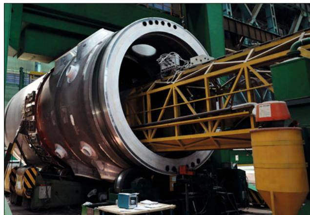
Параллельно с изготовлением корпуса реактора на заводе изготавливают внутрикорпусные устройства к нему, а также крышку реактора и верхний блок. На сегодняшний день изготовлен корпус внутрикорпусной шахты реактора, на завершающих стадиях – выгородка и блок защитных труб.
