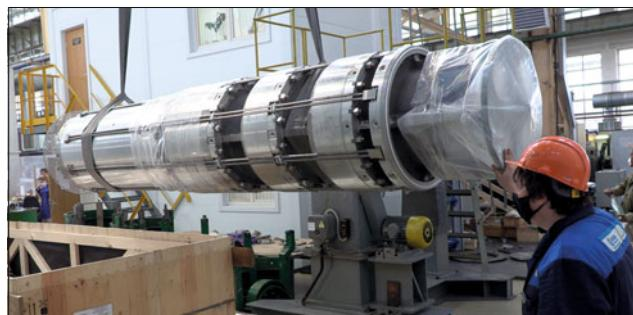
Номинальная подача насоса – 1750 м<sup>3</sup>/ч, при частоте вращения – 1500 об/мин и температуре перекачиваемой среды – минус 162°C.
