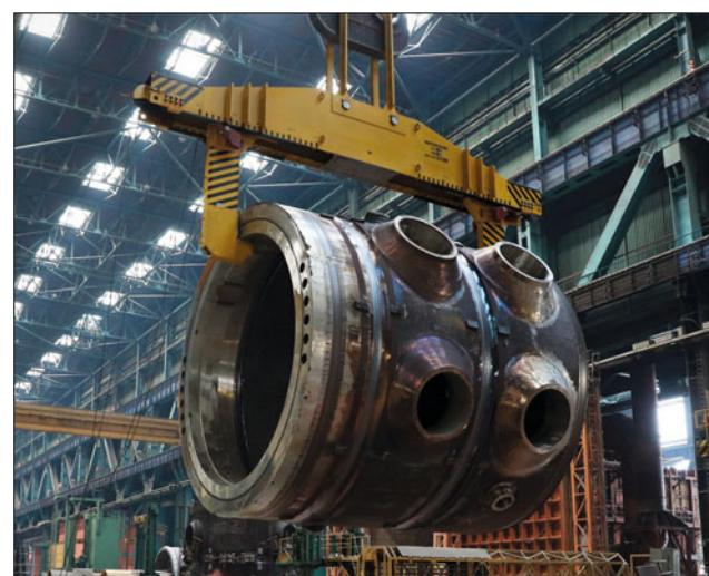
После сварки изделие нагревают до 270°C. С помощью мостового крана грузоподъёмностью 250 т, изделие переместили в печь на термообработку на 4 сут. Следующий этап изготовления атомного реактора для второго блока АЭС Руппур – сварка обечаек и днища нижнего полукорпуса.
