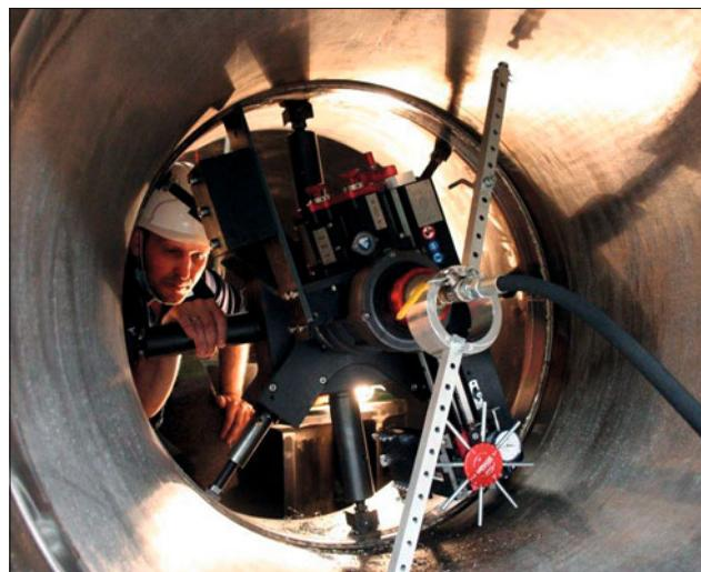
Применение мобильного станка в 4 раза повысит производительность труда на этой операции и, соответственно, сократит цикл изготовления корпуса ГЦН. Станок успешно прошёл приёмо-сдаточные испытания и после оформления ввода в эксплуатацию будет
