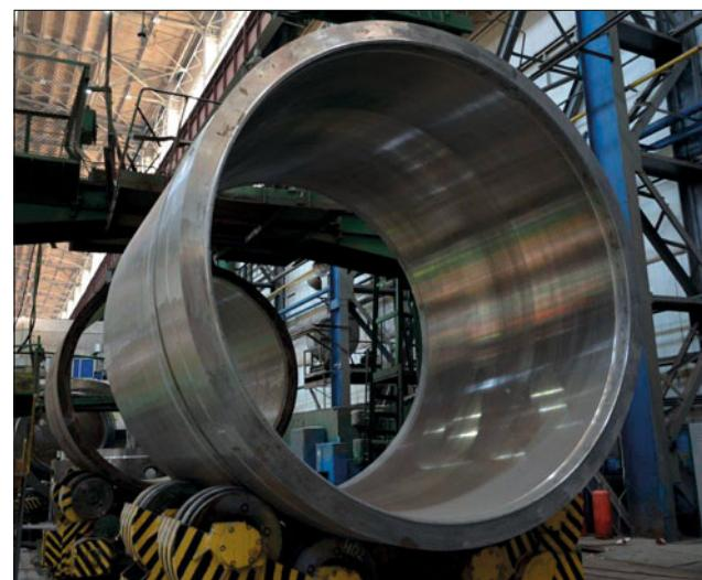
Корпус компенсатора давления представляет собой сварной сосуд, состоящий из четырёх цилиндрических толстостенных обечаек и двух эллиптических днищ.
