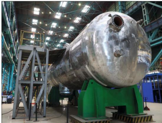
Успешно проведённые гидравлические испытания отражают высокое качество изготовленного изделия. В процессе изготовления оборудование проходит несколько видов испытаний и контролей. Помимо гидравлических парогенератор проходит также вакуумные испытания с помощью гелия, а также ультразвуковой, магнитно-порошковый, вихре-токовый контроли и рентено-гаммаграфирование. Всего к концу цикла изготовления парогенератора специалисты по качеству проведут 415 контрольных операций.
