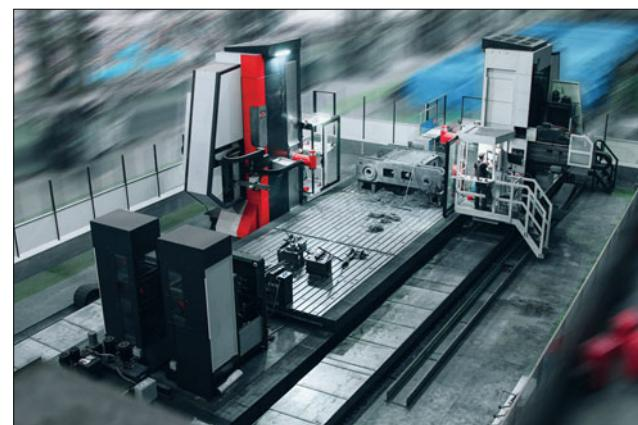
Новый обрабатывающий центр позволяет производить фрезерование, сверление, растачивание, резьбонарезание и другие виды механической обработки с высокими качествами точности. Уникальная установка позволит с точностью до нескольких микрон обрабатывать крупногабаритные детали длиной до 14 и шириной до 4 м.
