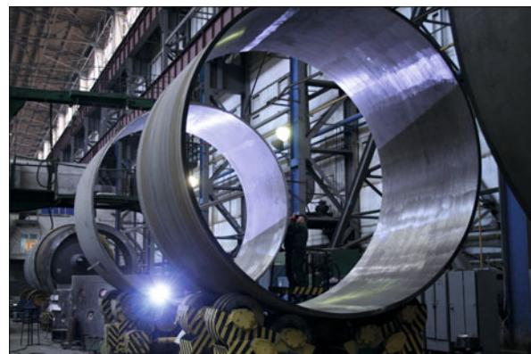
Для одной детали из заготовки шириной 2,5 м и длиной 13 м на листогибочной машине формируется цилиндр с внутренним диаметром 4,1 м. Петрозаводсмаш изготовил все 24 обечайки для комплекта ёмкостей СПЗАЗ АЭС “Аккую”. По-
