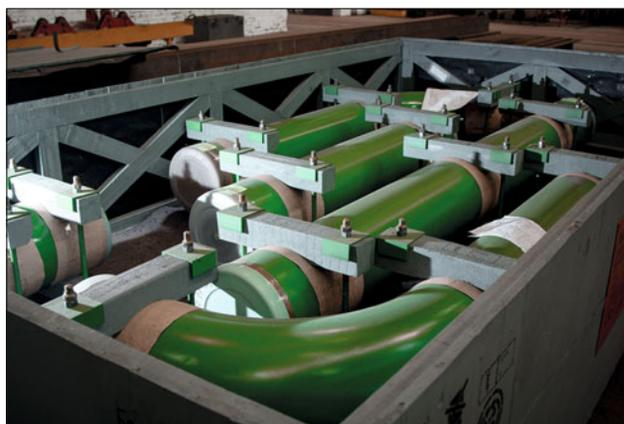
Трубопроводы ПИАР предназначены для соединения реактора с теплообменниками аварийного расхолаживания и баком аварийного запаса раствора бора. Система ПИАР используется для снижения интенсивности тепловыделения реактора до уровня, при котором не произойдет недопустимого перегрева внутриреакторных элементов конструкций, а также обеспечивает плановое расхолаживание первого контура во время останова реакторной установки и отвод остаточных тепловыделений при проведении перегрузки активной зоны.
