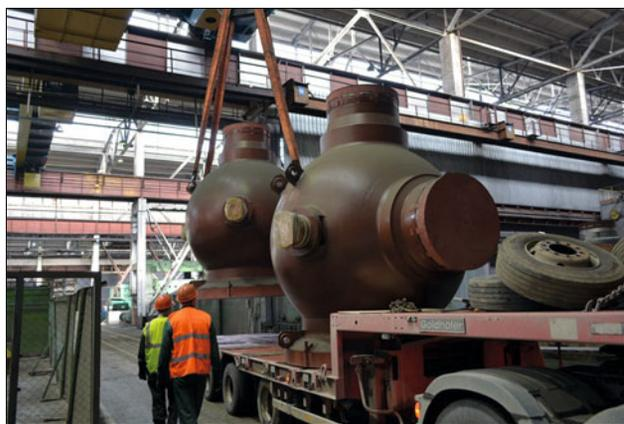
В настоящее время на Петрозаводскмаше находятся в активной фазе изготовления корпуса ГЦНА для второго энергоблока Курской АЭС-2.
