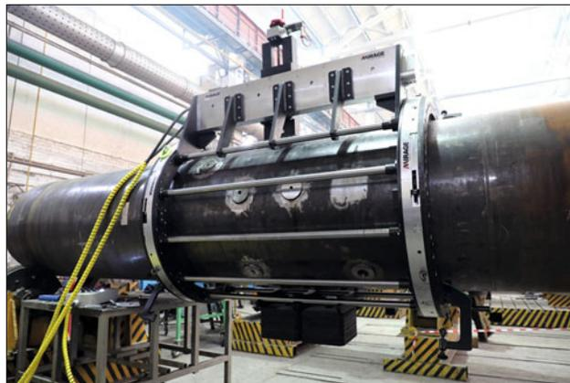
В сравнении со стационарными горизонтально-расточными станками, на которых в настоящее время ведётся обработка трубных узлов, мобильный станок имеет меньшую стоимость, меньшее электропотребление. При этом производительность выполнения операций сравнима. В наиболее важный момент – в период пиковой загрузки – данный мобильный комплекс позволит высвободить ключевое оборудование механической обработки для выполнения других, более сложных операций на крупногабаритных изделиях АЭС.
