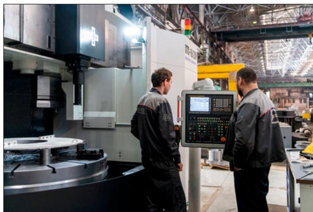
Новое высокоточное оборудование позволяет осуществлять обработку в соответствии с требованиями чертежа с точностью до 0,01 мм. Станок оснащён столом для обработки деталей массой до 8000 кг, диаметром до 2000 мм, высотой до 1600 мм. Стоимость проекта составила 59 900 тыс. руб.
