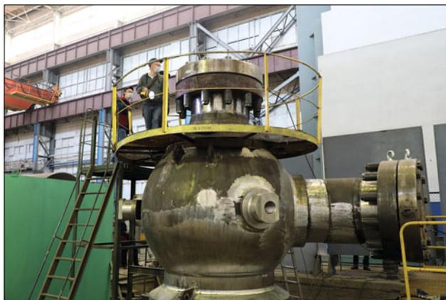
После снижения давления производят внешний осмотр корпуса ГЦН. Комиссия подтвердила, что первое изделие успешно выдержало испытание давлением. Далее внешнюю и внутреннюю поверхности корпуса насоса, а также кольцевые швы повторно проконтролируют методом цветной дефектоскопии.
