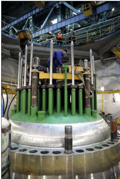
В ходе сборки сотрудники установили на корпус реактора шпонки крепления, зафиксировали приспособления для центровки крышки реактора. При контрольной сборке изделия полностью повторяют свое проектное положение. Это значительно сокращает сроки и упрощает монтаж реакторной установки на площадке строительства АЭС.
