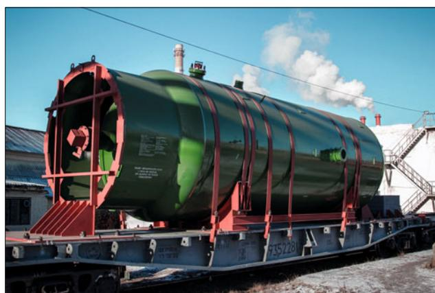
Ёмкости аварийного охлаждения зоны входят в состав реакторной установки, по одной на каждую петлю теплоносителя первого контура. САОЗ предназначена для автоматической подачи охлаждающего раствора борной кислоты в активную зону реактора в случае утечки теплоносителя и включается в работу при аварийной разгерметизации первого контура.
