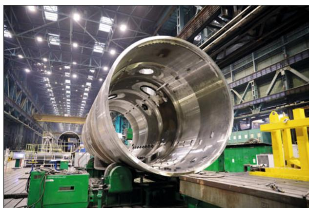
Также на завершающих этапах изготовление корпуса парогенератора, который состоит из четырех обечаек. Проводится сварка опорных листов, ведется подготовка под термообработку корпуса. Ещё три изделия проходят этапы наплавки, механической обработки и сборки-сварки кольцевых швов обечаек.
