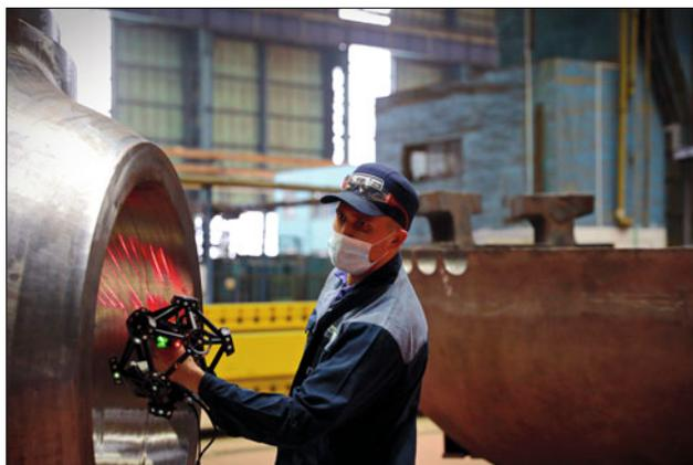
Оценка максимально точного значения параметров заготовок – одна из ключевых операций при входном и промежуточном контролях, за счёт которых обеспечивается высокое качество и безопасность при изготовлении сложного ядерного оборудования. Ранее размеры изделий выясняли при помощи многочисленных измерений на расточных и карусельных станках. Благодаря новой системе измерений сотрудники получают точные параметры в 5 раз быстрее. При этом высвободится от 300 до 600 нормо-часов станочного времени в год.
