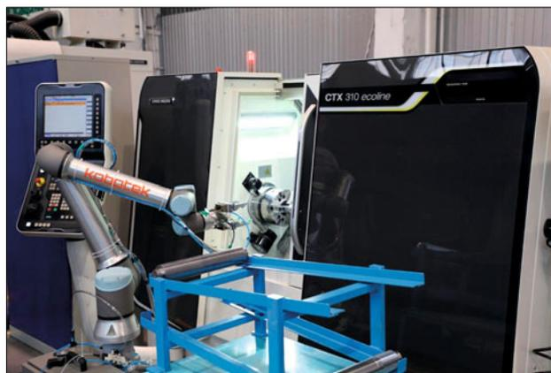
Роботизированная компанией «Коботек» установка включает в себя манипулятор с захватом, блок и пульт управления, подставки для заготовок и готовых изделий. Рука-манипулятор кобота имеет электромеханический привод и пневматический захват, автоматически позиционируется в пространстве и адаптируется к весу перемещаемой детали. Интервал сервисного обслуживания роботизированной установки составляет 3500 ч.
