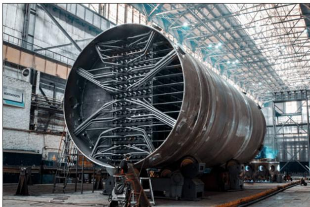
В процессе контрольной сборки специалисты завода произвели стыковку частей СПП: сепаратора и пароперегревателя друг с другом с помощью технологических планок. Контрольная сборка позволяет обеспечить соосность всех элементов. Изделия полностью повторяют свое проектное положение. Процесс позволяет значительно сократить сроки и упростить монтаж оборудования на площадке строительства атомной станции. Общая масса изделия в сборе составляет 263 т, длина аппарата – порядка 20 м, диаметр – 4,9 м.
