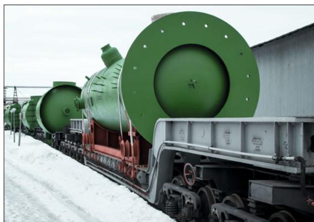
Подогреватели высокого давления ПВД-К-5 – элементы машинного зала атомной станции. ПВД – крупногабаритное изделие длиной свыше 11 м и массой 120 т. Выполняет функцию нагрева питательной воды, подаваемой в парогенератор за счёт охлаждения и конденсации пара, отбираемого из промежуточных ступеней турбины.
