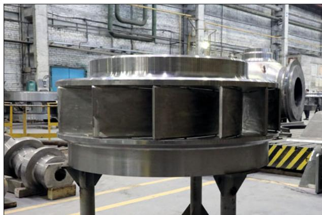
Корпус ГЦНА – изделие первого класса безопасности. На атомной электростанции главный циркуляционный насосный агрегат обеспечивает циркуляцию теплоносителя в первом контуре и работает под давлением около 160 МПа и при температуре 300°C.
