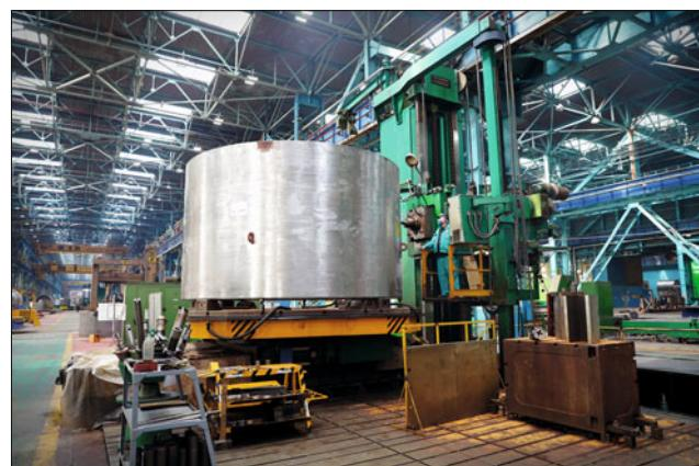
СПЗАЗ относится ко второй ступени пассивных систем безопасности АЭС. Система включает в себя 8 гидроёмкостей объёмом по 120 м<sup>3</sup>. Во время эксплуатации на станции в ёмкостях хранится водный раствор борной кислоты, подогретый до температуры около 60°C. При падении давления в первом контуре ниже определённого уровня происходит автоматическая подача жидкости в реактор и охлаждение активной зоны.
