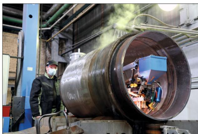
Главный циркуляционный трубопровод внутренним диаметром 850 мм, общей длиной 146 м соединяет основное оборудование первого контура АЭС: реактор, парогенераторы и главные циркуляционные насосы. Он предназначен для циркуляции теплоносителя первого контура при температуре до 330°C под высоким давлением – 160 атм.
