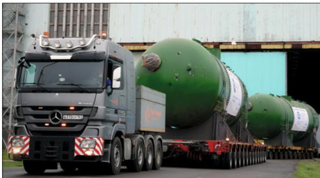
Реактор массой 320 т, длиной 12 м и два 340-тонных парогенератора длиной 14 м привезут на заводской спецпричал и погрузят на баржу. По воде оборудование доставят в Новороссийск, затем изделие отправится по морю в Республику Бангладеш. Морской путь составит порядка 14 000 км.
