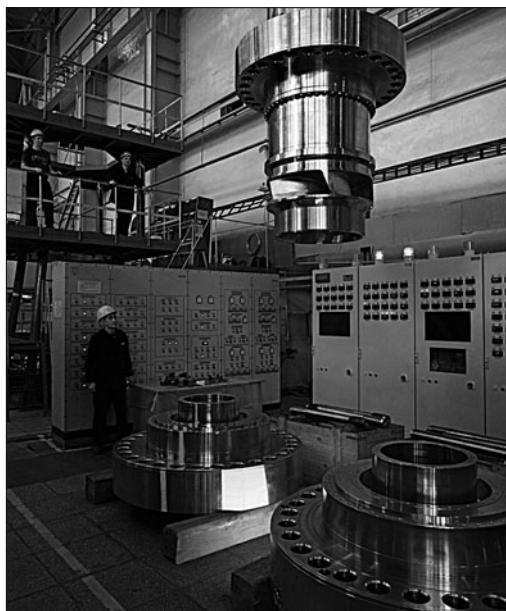
Ресурсные испытания серийного ГЦНА-1753 проводятся на производственной площадке “ЦКБМ 2” в г. Сосновый Бор. На полномасштабном стенде, имитирующем условия работы реакторной установки, агрегат должен отработать 5000 ч в условиях, полностью соот-
