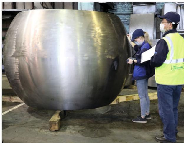
Корпус ГЦНА – изделие первого класса безопасности. На атомной электростанции главный циркуляционный насосный агрегат обеспечивает циркуляцию теплоносителя в первом контуре и работает под давлением около 160 МПа и при температуре 300°C. В состав оборудования реакторной установки одного энергоблока входит четыре ГЦНА.
