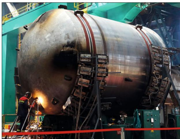
*В Волгодонском филиале АО “АЭМ-технологии” “Атоммаш” (входит в машиностроительный дивизион Росатома – Атомэнергомаш) собрали нижний полукорпус реактора для блока ст. № 7 Тяньваньской АЭС (Китай).* Специалисты сначала собрали в вертикальное положение днище, обечайку активной зоны и фланец. Сборка элементов диаметром 4,5 м проводится
