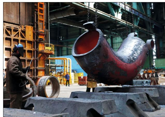
Главные циркуляционные трубопроводы (ГЦТ) предназначены для соединения основного оборудования первого контура АЭС: реактора, парогенераторов и главных циркуляционных насосов. По ним циркулирует теплоноситель – вода с температурой 320°C и давлением до 17,6 МПа. Трубопроводы относятся к первой категории сейсмостойкости и способны выдержать землетрясение в девять баллов. Общая протяженность трубопровода – более 160 м.
