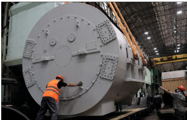
Также НПО “ЭЛСИБ” поставит на Пермскую ТЭЦ-9 и Ижевскую ТЭЦ-2 два турбогенератора ТФ-130-2УХЛ3. Турбогенераторы серии ТФ с воздушным охлаждением поставляются на объекты “Т Плюс” в рамках федеральной программы модернизации тепловых электростанций (ДПМ-2) взамен выработавших свой ресурс турбогенераторов с водородным охлаждением.
