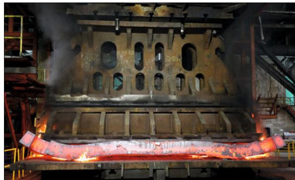
В соответствии с технологией специалисты вновь направили заготовку в печь для дополнительного нагрева в течение двух часов. В ходе второго этапа разгибы усилие пресса составляет максимальные 15 000 т. В результате трубная заготовка полностью превращается в квадратный лист. Из листа будет вырезан круг для формирования днища атомного реактора.
