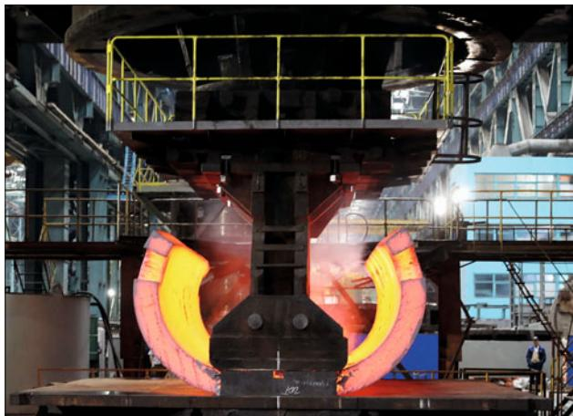
Разгибка позволяет получить бесшовную заготовку размером 6 × 6 м для формирования днища атомного реактора. Листовые поковки таких габаритов не транспортабельны, а технология изготовления не допускает сварных соединений на изделии.
