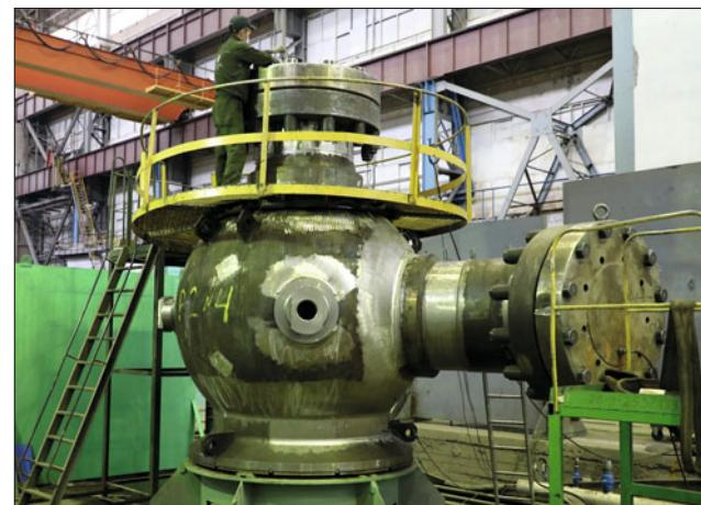
Гидравлические испытания – один из самых важных видов контроля корпусов насосов, которые проводятся при изготовлении. Он позволяет убедиться в прочности и плотности изделий. При проведении испытаний корпус ГЦНА заполняют специально подготовленной очищенной и подогретой водой, давление нагнетают до 24,5 МПа (более 240 атм). После снижения давления производят внешний осмотр корпуса. Комиссия подтвердила, что первое изделие успешно выдержало гидроиспытания.
