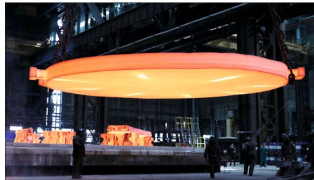
Круглая заготовка массой 64 т и толщиной 300 мм прошла трёхступенчатый нагрев на протяжении 6 ч при максимальной температуре 1020°C. Затем с помощью крана заготовку переместили в штамповую оснастку и применили пресс с усилием 10 000 тс.
