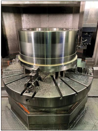
В реакторе БРЕСТ-ОД-300 мощностью 300 МВт в качестве теплоносителя будет применяться расплав свинца с номинальной температурой 420°C. К циркуляционным насосам, работающим в агрессивной коррозионно-активной высокотемпературной среде, предъявляются повышенные требования. Всего в компоновке реактора предусмотрено использование четырёх вертикальных агрегатов с насосами погружного типа, которые ЦКБМ планирует изготовить в 2025 г.
