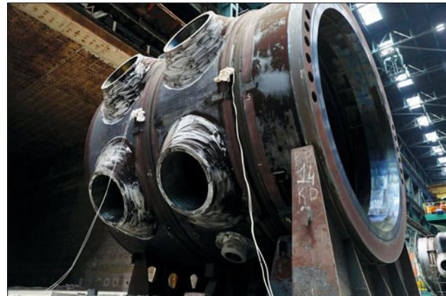
Реактор – изделие первого класса безопасности, представляет собой вертикальный цилиндрический корпус с эллиптическим днищем. Внутри изделия размещается активная зона и внутрикорпусные устройства. Сверху корпус герметично закрыт крышкой с установленными на ней приводами механизмов и органов регулирования и защиты, патрубками для вывода кабелей датчиков внутриреакторного контроля.
