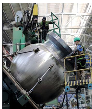
Предварительно были собраны устройства внутреннего насыщения ГЦНА – направляющие аппараты. Затем их соединили с фланцами. После данную конструкцию поместили в сферический корпус и выполнили соответствующий кольцевой шов. Сборка со сферой выполнена на всех 4-х корпусах ГЦНА для станции Тяньвань.
