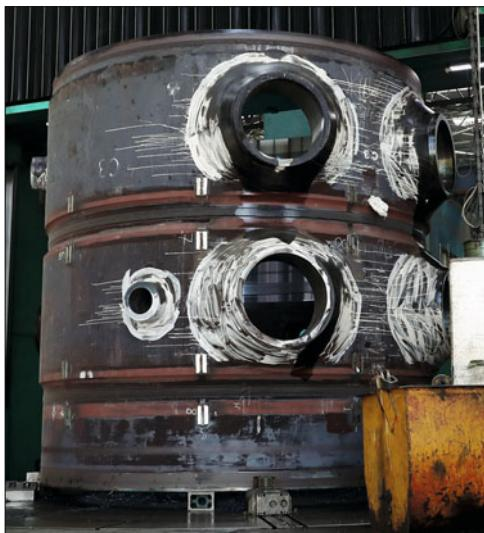
Реактор – изделие первого класса безопасности, представляет собой вертикальный цилиндрический корпус с эллиптическим днищем. Внутри изделия размещается активная зона и внутрикорпусные устройства. Сверху корпус герметично закрыт крышкой с установленными на ней приводами механизмов и органов регулирования и защиты, патрубками для вывода кабелей датчиков внутриреакторного контроля.
