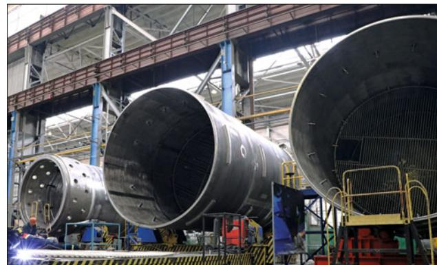
СПЗАЗ относится ко второй ступени пассивных систем безопасности АЭС; предназначена для отвода остаточных тепловыделений теплоносителя первого контура реактора. Во время эксплуатации на станции в ёмкостях хранится водный раствор борной кислоты, подогретый до температуры около 60°C. При падении давления в первом контуре ниже определённого уровня происходит автоматическая подача жидкости в реактор и охлаждение активной зоны.
