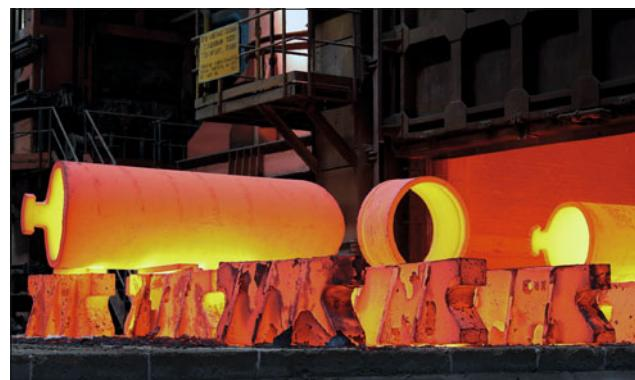
Главные циркуляционные трубопроводы (ГЦТ) предназначены для соединения основного оборудования первого контура АЭС: реактора, парогенераторов и главных циркуляционных насосов. По ним циркулирует теплоноситель – вода с температурой 320°C и давлением до 17,6 МПа. Трубопроводы относятся к первой категории сейсмостойкости и способны выдержать землетрясение в девять баллов. Общая протяженность трубопровода – более 160 м.
