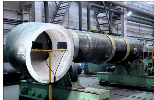
Кроме того, на Петрозаводском заводе завершили изготовление плакированных трубных заготовок для ГЦТ другой атомной станции Китая – АЭС Сюйдапу, энергоблок № 3. Заготовки также переданы для дальнейшей сборки трубных узлов.
