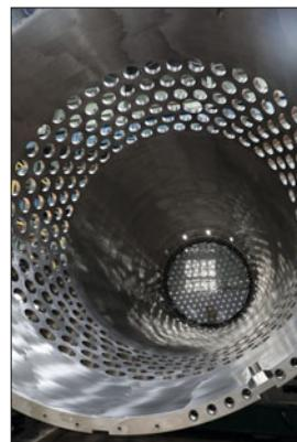
В верхней части шахты 238 отверстий диаметром 196 мм и два отверстия диаметром 300 мм. Отверстия расположены в
