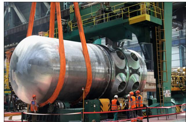
Следующий этап – контрольные операции. Специалисты проведут весь спектр контрольных мероприятий в зонах сваренного шва: рентгенографическую дефектоскопию, ультразвуковой и капиллярный контроли.
