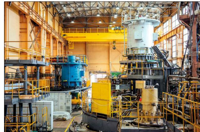
Ресурсные испытания ГЦНА-1753 проводятся в филиале “ЦКБМ 2” в г. Сосновый Бор на полномасштабном стенде, имитирующем условия работы реакторной установки, и идут больше года. Продолжительное время испытаний обусловлено тем, что модель насоса ГЦНА-1753 будет установлена впервые на АЭС. Испытания на стенде позволяют тщательно подготовить и доработать новое оборудование до передачи заказчику. Помимо Курской АЭС, насосами ГЦНА-1753 будет укомплектована строящаяся АЭС Аккую в Турции.
