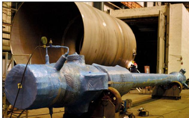
В ходе ремонта третьего блока Белоярской АЭС необходимо заменить еще 16 таких модулей, которые уже изготавливаются на “ЗиО-Подольск”. Они будут производить 660 т/ч пара высокого давления.
