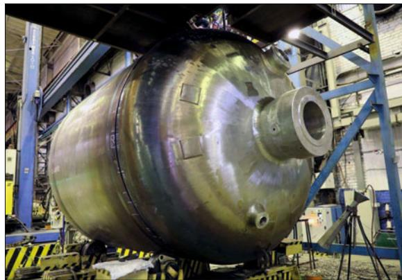
Компенсатор давления является ключевым оборудованием реакторного зала АЭС. Он предназначен для создания и поддержания давления в первом контуре реактора. Аппарат представляет собой толстостенный сосуд с толщиной стенки 160 мм, внутренний объём изделия 79 м<sup>3</sup>, масса изделия в сборе – 178 т.
