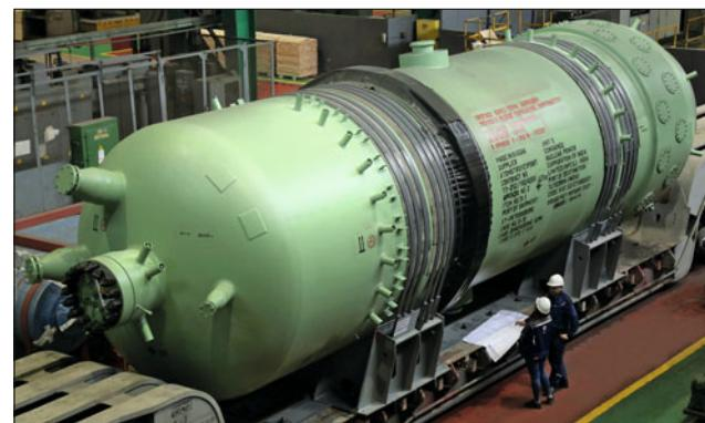
В ходе гидравлических испытаний сосуд выдержал проверку на герметичность при воздействии высоких температур и максимально допустимого давления в 24,7 МПа. Сегодня изделие отправляется к заказчику. До места назначения компенсатору давления предстоит преодолеть более 17 тыс. км.
