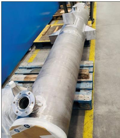
Цеолитовые фильтры – новый продукт для ЦКБМ, конструкторская документация для этих изделий была разработана инженерами предприятия в 2021 г. с нуля. Первые четыре фильтра отгружены в марте 2023 г. на строящийся в Китае блок № 7 Тяньваньской АЭС.
