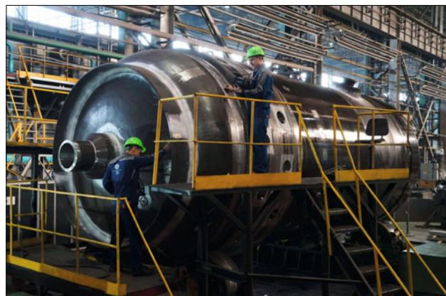
Компенсатор давления является ключевым оборудованием реакторного зала АЭС. Он нужен для создания и поддержания давления в первом контуре реактора. Аппарат представляет собой толстостенный сосуд с толщиной стенки 157 мм, внутренний объём изделия – 79 м<sup>3</sup>, масса в сборе – 186 т.
