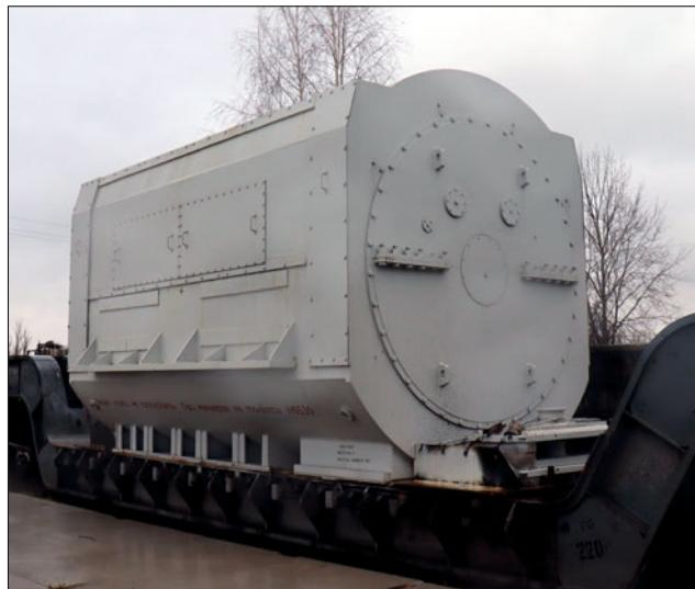
Новые генераторы с воздушным охлаждением заменят старые машины с водородным охлаждением, изготовленные сибирскими машиностроителями более 40 лет назад. Современное генерирующее оборудование продлит срок эксплуатации станции, обеспечит надёжность теплоснабжения, а также позволит подключать больше потребителей.
