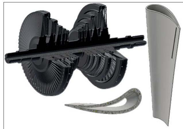
Устройство представляет собой совокупность полых сопловых лопаток специальной конструкции и системы подвода греющего пара. Жидкая пленка испаряется с поверхностей подогреваемых паром лопаток, а неиспарившаяся влага дробится в потоке греющего пара. При этом пар выдувается через специальные щели, выполненные на поверхности лопаток вблизи выходной кромки.
