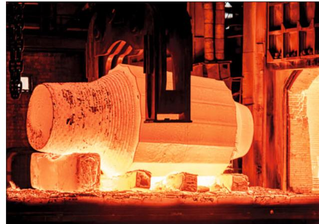
Ковка заготовок – один из начальных этапов производства реакторного оборудования. Операция производится на одном из крупнейших в Европе автоматизированном кузнецком комплексе. После придания заготовкам необходимой формы, детали будут переданы в другой цех для механической обработки. В последствии из них будут изготовлены две обечайки реактора ВВЭР-1200 поколения III+.
