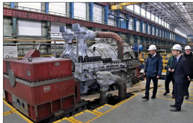
Турбина будет установлена взамен устаревшей машины, работавшей на станции с 1964 г. В результате реконструкции будет повышена надёжность электро- и теплоснабжения столицы Бурятии, повышенены технико-экономические показатели ТЭЦ. Современная система регулирования нового агрегата обеспечит манёвренность его работы на различных режимах, кроме того, заложенные конструкторские решения повысят эффективность работы на теплофикационных режимах, что особенно важно для климатических условий региона.
