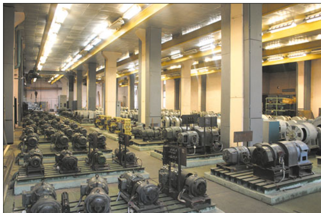
Цифроаналого-физический комплекс (ЦАФК): 166 моделей комплексной нагрузки и 66 модельных генераторов
